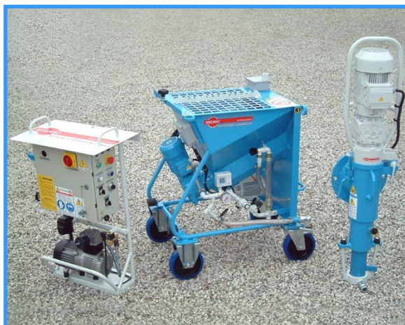
Ck 20 smontata in 3 parti per facilitarne il trasporto.
